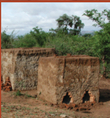
Tre fältugnar för tegel från Zimbabwe, bränningen avslutad. Foto Anders Lindahl.
