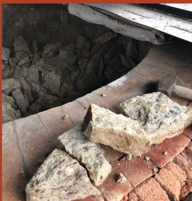
Mynningen av kulturkalks kalkugn efter en lyckad bränning och uttagning av stenen.
